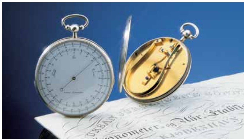
Thermomètre bimétallique Jürgensen installé dans une boîte de montre. Les premiers ont été construits dans les ateliers Houriet.
