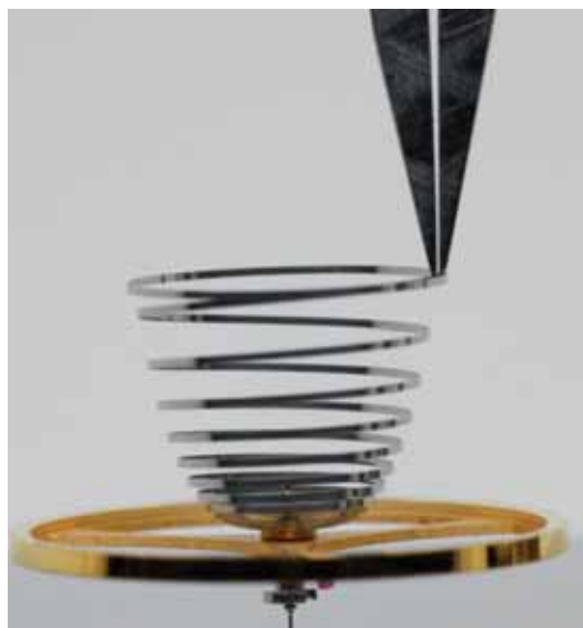
Un mouvement, un cadran, des aiguilles et un balancier spiral pour la montre école W-01.
