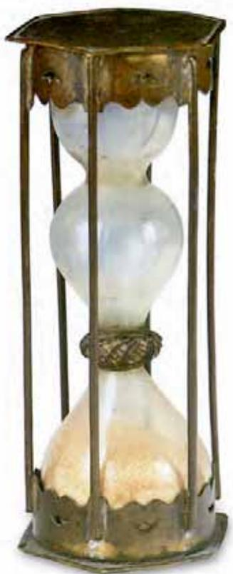
Le sablier est né en même temps que l'horlogerie au XIII<sup>e</sup> siècle. Transportable, il n'a rien à voir avec la clepsydre même s'il laisse couler le temps. Il ne contient pas de sable, mais du lait de sciage de marbre, séché et teinté de bon vin.
