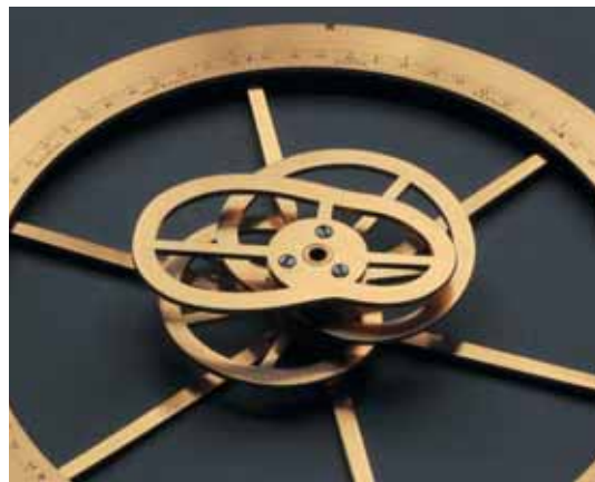
Jahresrad mit den Kurvenscheiben für Zeitgleichung, Sonnenauf- und -untergang.
